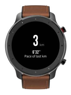
**Приостановка и завершение тренировки** Когда включена функция автоматической паузы, запись данных приостанавливается при остановке тренировки. После возобновления тренировки часы автоматически снимают статус паузы и продолжают запись данных.
