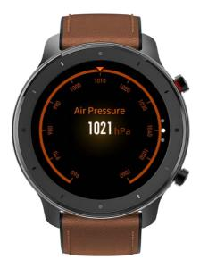
Проведите вверх на странице давления воздуха, чтобы перейти на страницу высоты. Для получения данных о высоте требуется откалибровать барометр и модуль GPS часов. Если требуются более точные данные о высоте, попробуйте выполнить позиционирование по спутнику на открытой местности.
