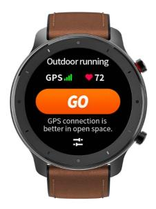
Если процесс позиционирования занимает много времени, это может быть связано с тем, что ближайшие здания блокируют сигнал спутника или часы отключились от приложения на длительное время, что вызвало устаревание данных AGPS. Откройте приложение Amazfit, подключите его к часам и повторите попытку после обновления данных AGPS.
